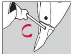
Tourner la clavette dans le sens contraire à celui des aiguilles d'une montre
